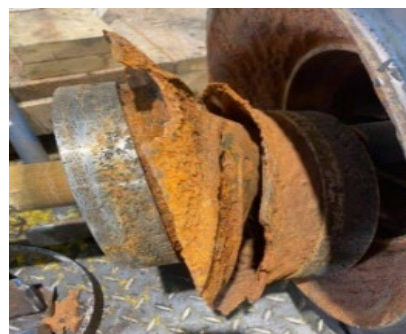
Зураг 3. Зэвэрсэн насосны ажлын дугуй
